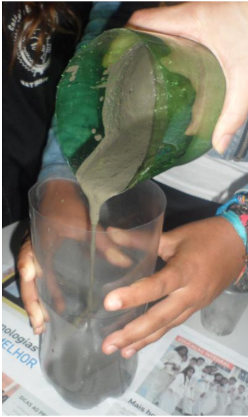
Figuras 07 e 08 – colocação da argamassa para regularizar o fundo do pluviômetro e posicionando a régua.
