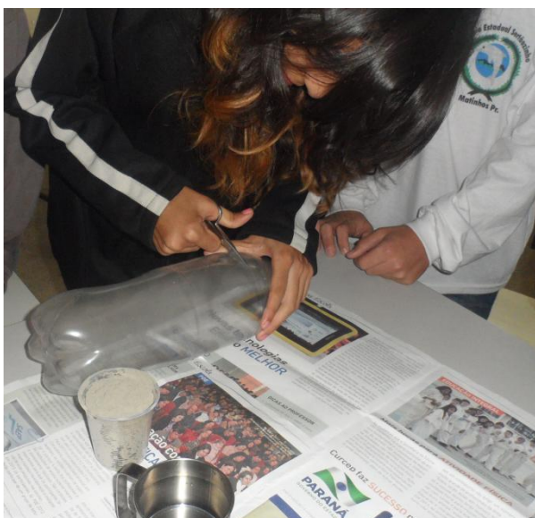
Figuras 05 e 06 – cortando e preparando a garrafa pet para construção do pluviômetro. Fonte: o autor
