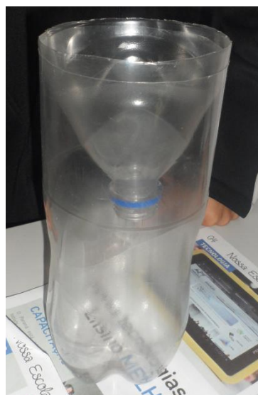
Figuras 05 e 06 – cortando e preparando a garrafa pet para construção do pluviômetro. Fonte: o autor
