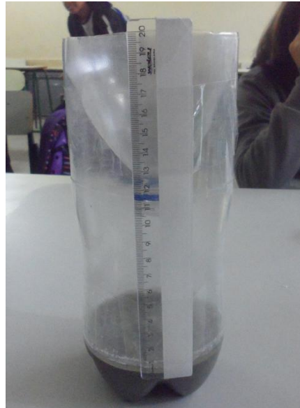
Figuras 09 e 10 – Pluviômetro construído pelos estudantes do 8ºC do Colégio Estadual Sertãozinho 2014.
