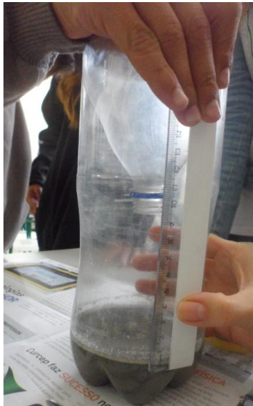
Figuras 09 e 10 – Pluviômetro construído pelos estudantes do 8ºC do Colégio Estadual Sertãozinho 2014.
