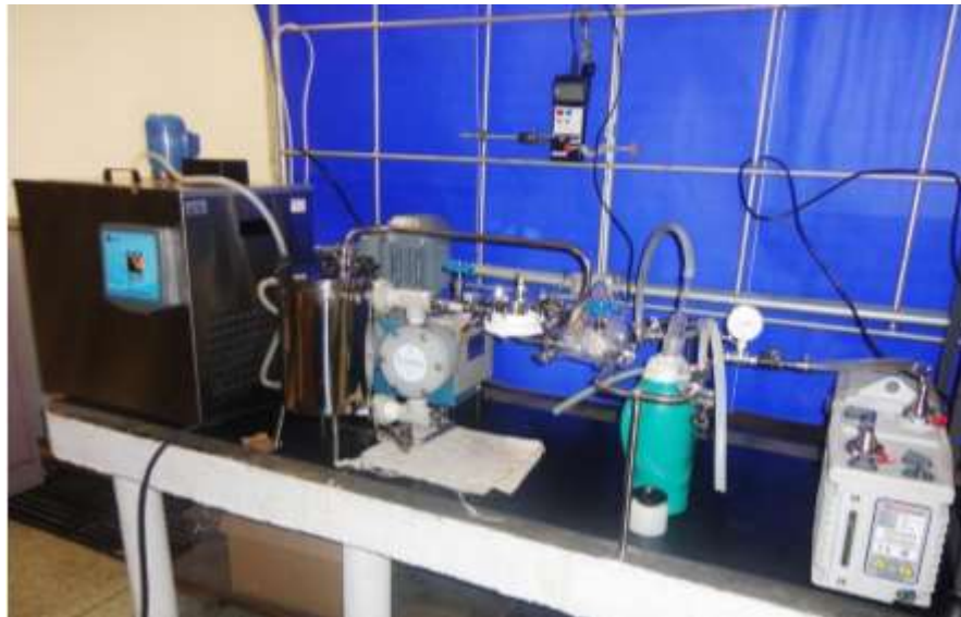
FIGURA 15 - ILUSTRAÇÃO DA UNIDADE EXPERIMENTAL DE PERVAPORAÇÃO (EMULTEC-UFPR)
