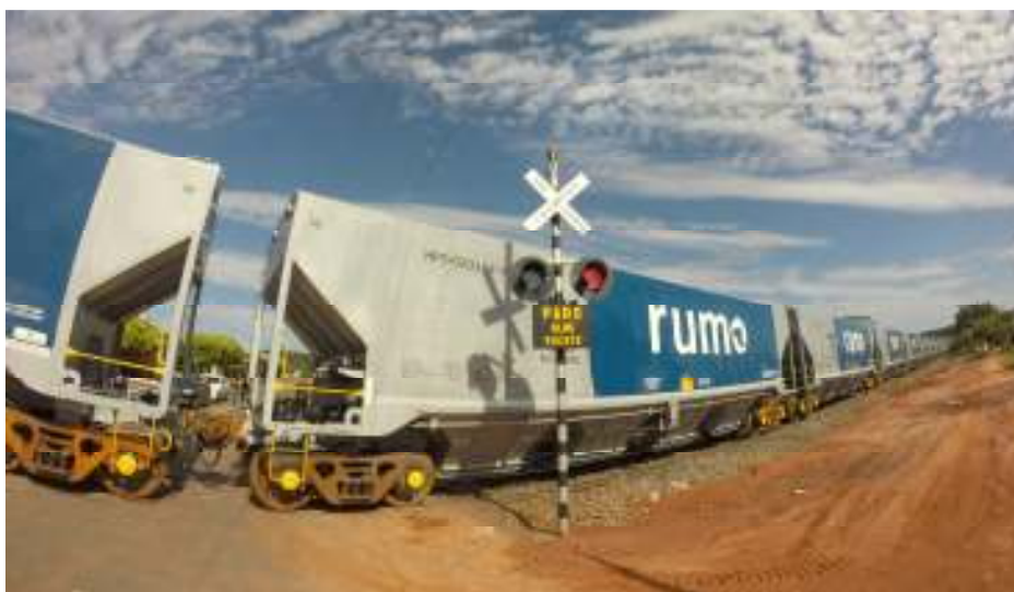
Figura 16 – Cruz de Santo André Instalada
