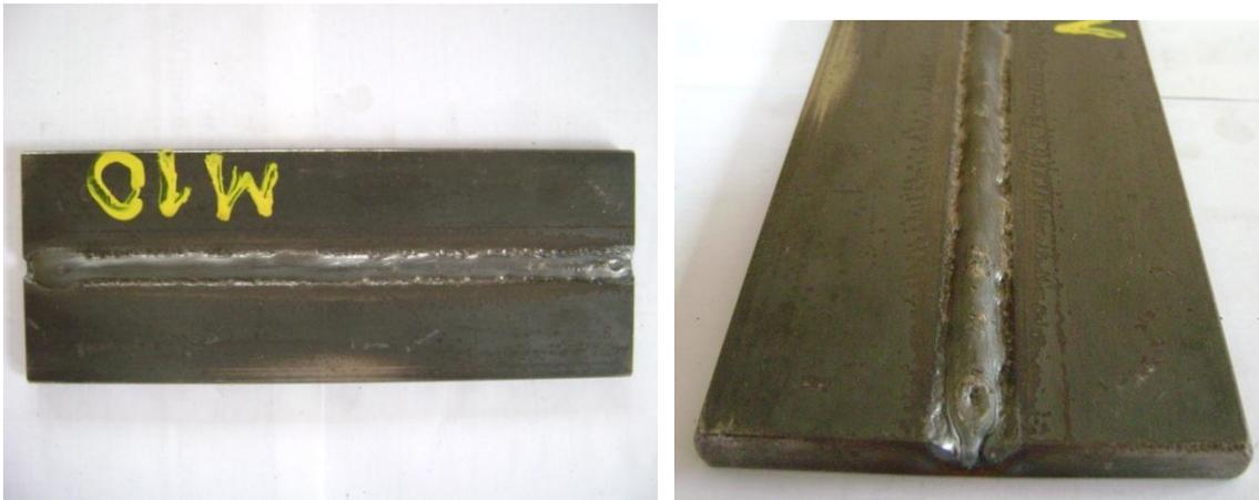
**Figura 4.4 – Chapa soldada com arame maciço 300 A.**
