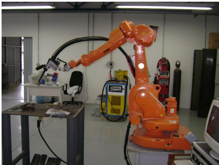
**Figura 3.3 – Robô de soldagem utilizado.**
