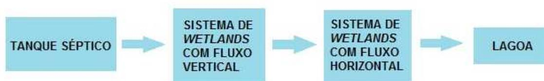
Figura 15: Esquema do processo a ser implantado no Zoológico Municipal de Curitiba.
