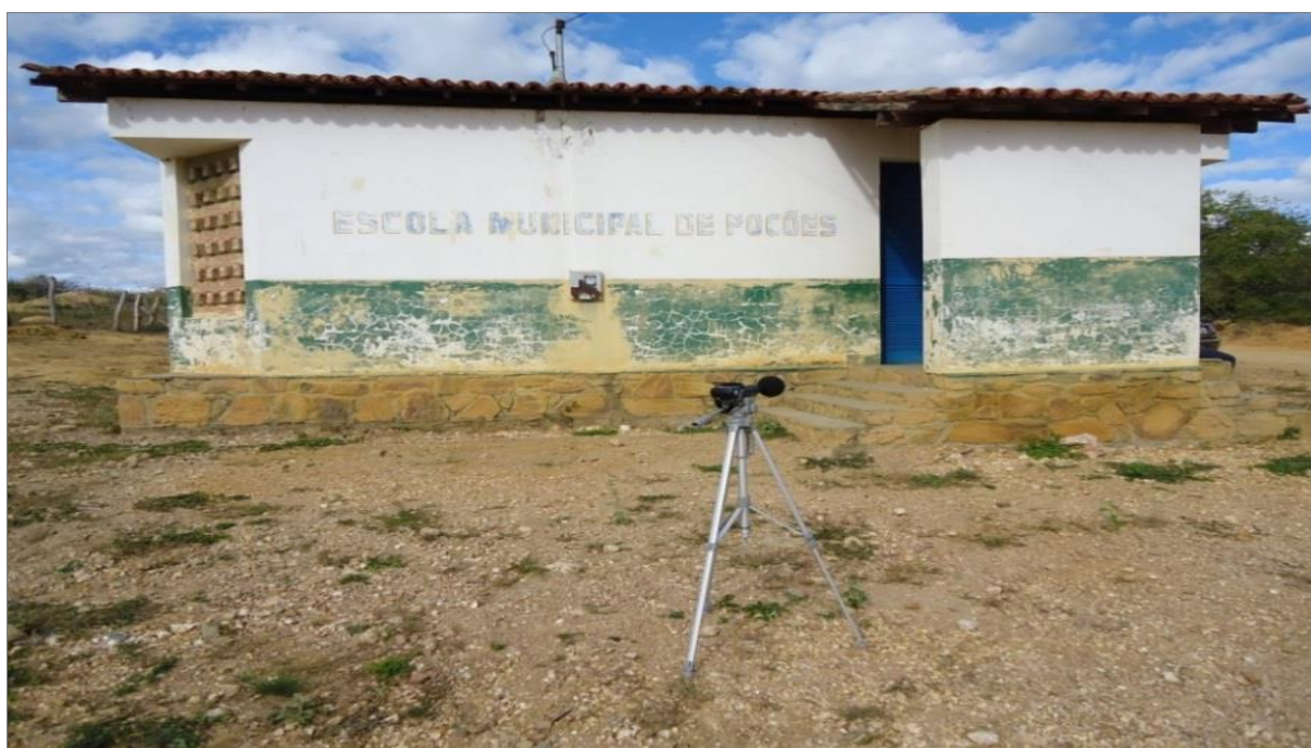
FIGURA 31 – CONTROLE E MONITORAMENTO DE RUÍDO (PBA Nº P16) FONTE: O AUTOR (2013).
