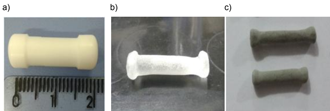
Figura 7. Barras de agitação magnéticas confeccionadas: a) barra de PTFE; b) barra de vidro com C18 e c) barra de epóxi com C18
