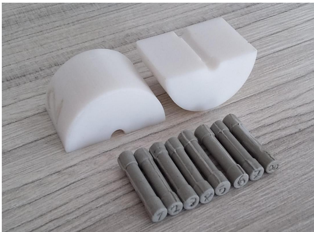
Figura 8. Barras de resina epóxi confeccionadas e o molde de PTFE utilizado na confecção das mesmas
