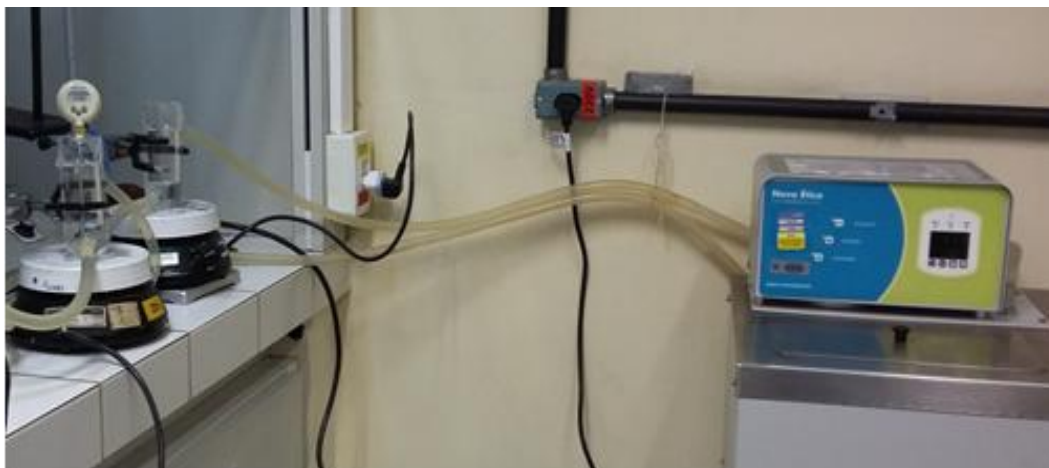
Figura 27. a) Recipientes térmicos acomodados sobre agitadores magnéticos; e b) banho termostático para ajuste da temperatura dos experimentos
