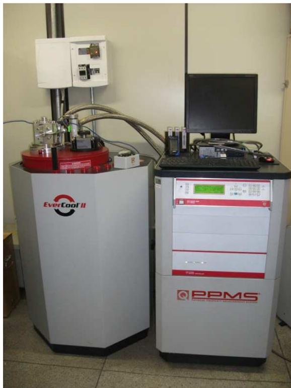
**Fig. 3.15** - PPMS Ever Cool II da Quantum Desing instalado no Laboratório de Caracterização Magnética de Materiais da UFPR.
