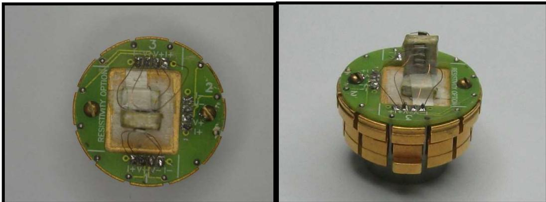
**Fig. 3.20** – Suporte de amostra (“puck”) para medidas de transporte no PPMS. Configuração utilizada para medidas de resistividade longitudinal.
