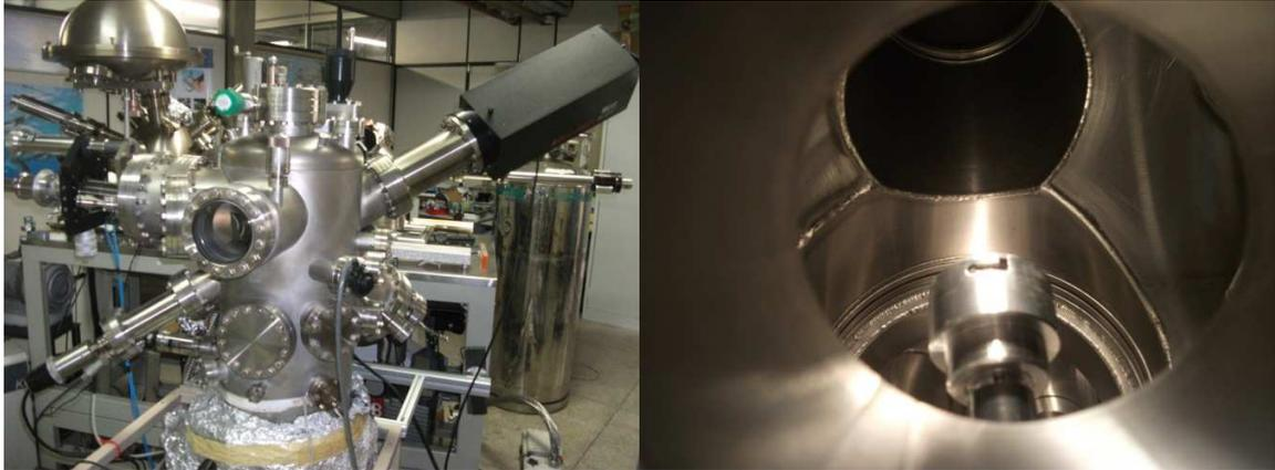
**Fig. 3.2** – (a) Câmara MBE e Câmera tipo CCD (caixa escura) em primeiro plano; (b) Visão interna do porta-amostra dentro da câmara MBE em frente a abertura do túnel de carregamento.
