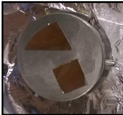
Fig. 3.4 - Conjunto “*molyblock*”+substrato.
