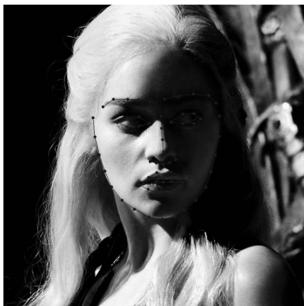
Figura 2.1: Exemplo da base de dados 300W [43] com os 68 pontos fiduciais 2d fornecidos. Os pontos foram conectados para facilitar a visualização da geometria da face.
