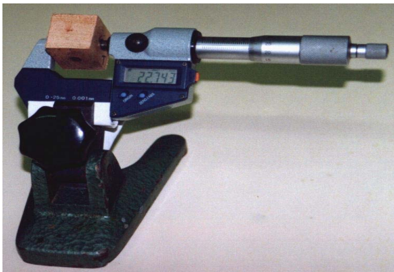
Figura 21. Esquema da medição das contrações radiais e tangenciais
