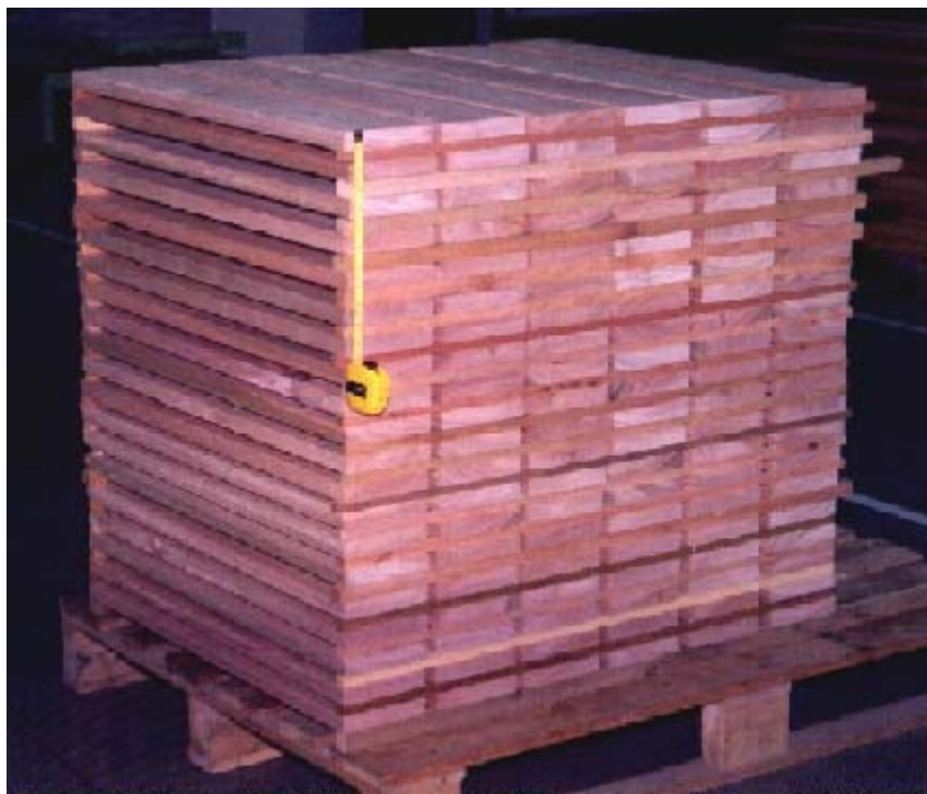
Figura 23. Corpos-de-prova para os testes de usinagem, entabecados sobre pallets nas salas de máquinas do SENAI/CETMAM.
