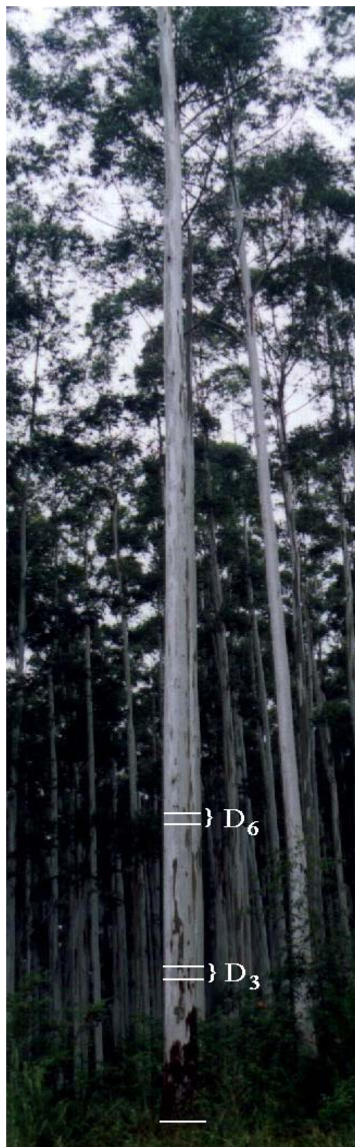
Figura 15. Esquema de retirada da segunda tora de três metros de comprimento, localizada entre três e seis metros de altura e os discos D_3 , a três metros e D_6 , a seis metros.
