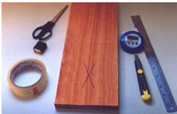
Figura 29. Teste de aderência do verniz através do destacamento na intersecção e ao longo das incisões pelo método de incisões cruzadas, detalhe do material necessário.
