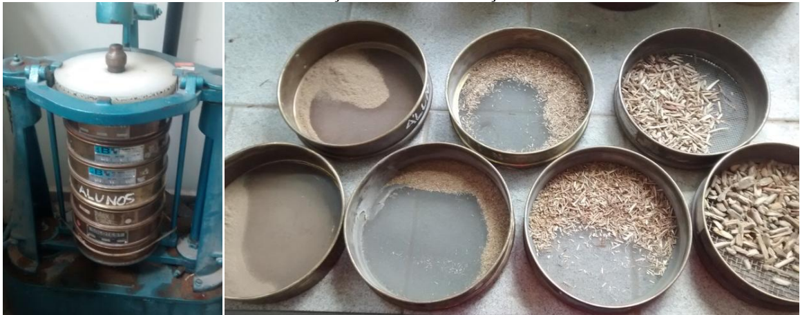
FIGURA 3.9 – DETERMINAÇÃO DA COMPOSIÇÃO GRANULOMÉTRICA
