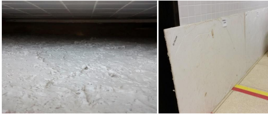
FIGURA 3.38 - PLACA COM COMPÓSITO DE GESSO-MADEIRA DESFORMADA
