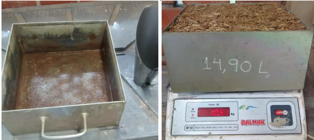
FIGURA 3.8 – DETERMINAÇÃO DA MASSA UNITÁRIA
