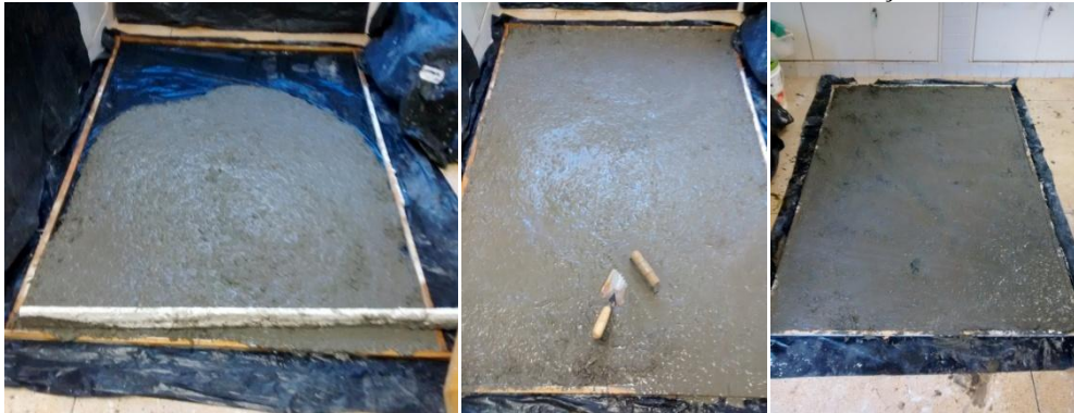
FIGURA 3.25 - COMPÓSITO DE CIMENTO-MADEIRA COM RELAÇÃO A/C=0,65
