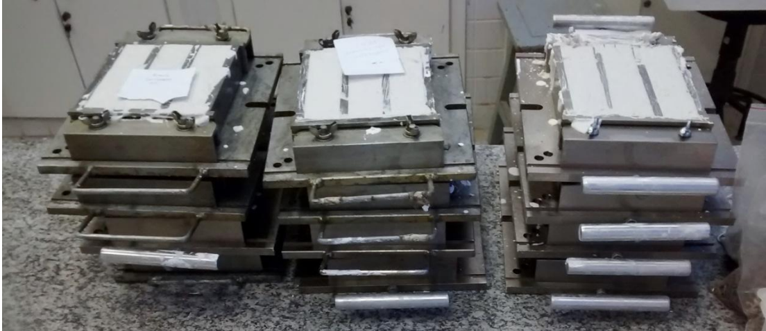
FIGURA 3.30 – CORPOS DE PROVA MOLDADOS COM COMPÓSITO DE GESSO-MADEIRA
