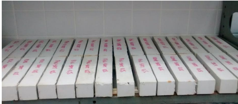
FIGURA 3.31 – DISPOSIÇÃO DOS CORPOS DE PROVA DO COMPÓSITO DE GESSO-MADEIRA NA CÂMARA SECA
