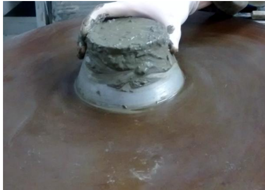
FIGURA 3.16 – PREPARO DO MATERIAL PARA O ENSAIO DO ÍNDICE DE CONSISTÊNCIA DO COMPÓSITO DE CIMENTO-MADEIRA
