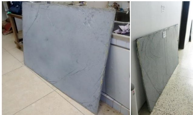
FIGURA 3.26 - PLACA COM COMPÓSITO DE CIMENTO-MADEIRA DESFORMADA
