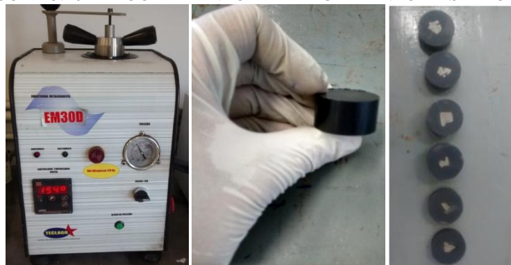
FIGURA 3.20 – PROCEDIMENTO DE EMBUTIMENTO DAS AMOTRAS
