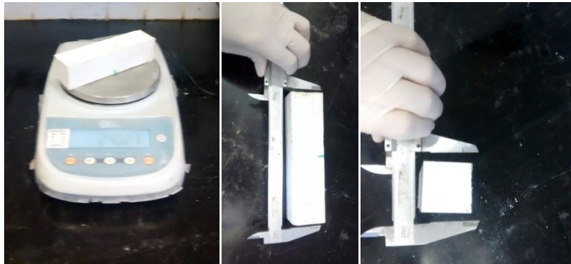
FIGURA 3.33 – PROCEDIMENTOS PARA DETERMINAÇÃO DA DENSIDADE DE MASSA ENDURECIDA DO COMPÓSITO DE GESSO-MADEIRA
