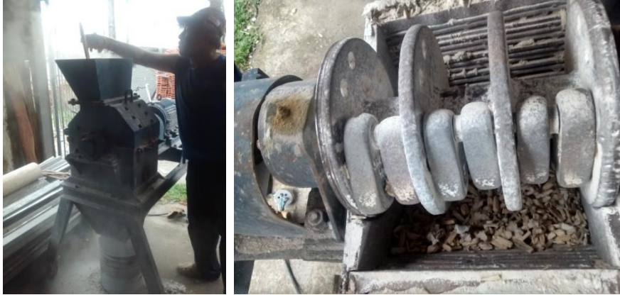
FIGURA 3.4 – MOINHO DE MARTELOS UTILIZADO PARA A MOAGEM DA MADEIRA
