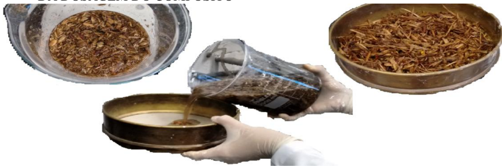
FIGURA 3.29 – PROCEDIMENTO DE SATURAÇÃO DAS PARTÍCULAS DE MADEIRA NO MOMENTO DA DOSAGEM DO COMPÓSITO
