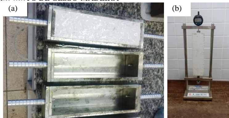
FIGURA 3.35 – MOLDAGEM (A) E DETERMINAÇÃO DA VARIAÇÃO DIMENSIONAL (B) DO COMPÓSITO DE GESSO-MADEIRA
