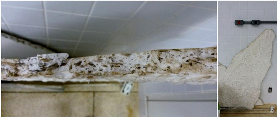
FIGURA 3.39 – DETALHES DA PLACA COM COMPÓSITO DE GESSO-MADEIRA QUEBRADA
