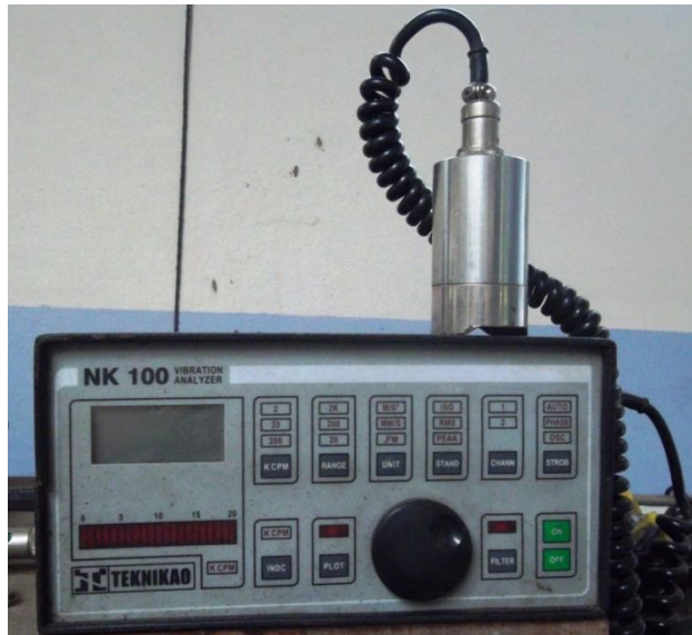
Fig. 4.13 - Analisador de Vibrações e Acelerômetro utilizados. Fonte: autor.
