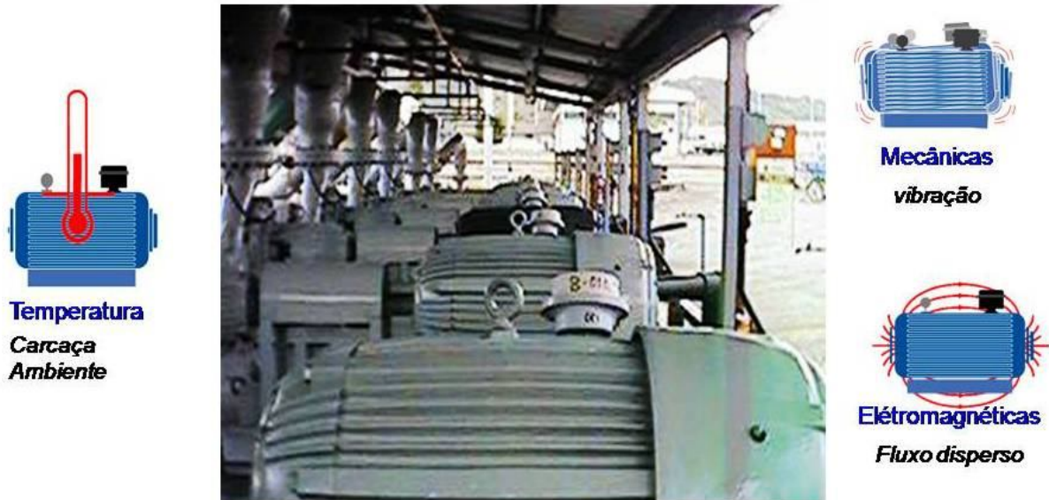
Fig. 2.8 - Sistema de monitoramento que utiliza multi-fatores
