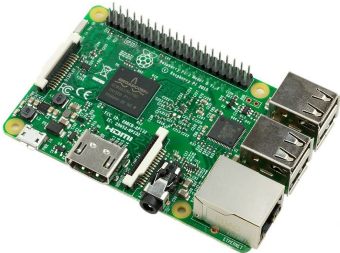
Figura 13:Placa de desenvolvimento Raspberry Pi Modelo v3
