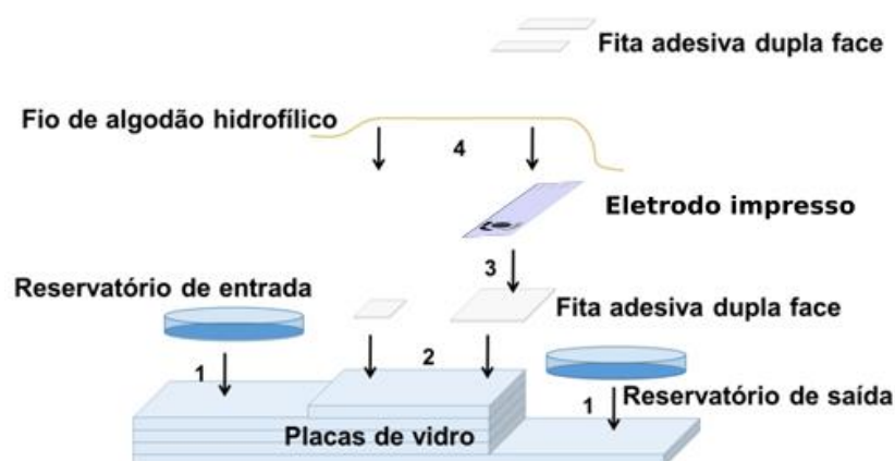
FIGURA 50: ESQUEMA DE CONSTRUÇÃO DO \mu TED
