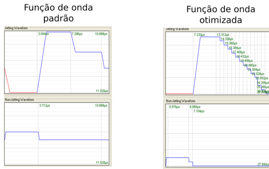
FIGURA 72 – FUNÇÃO DE ONDA INICIAL E OTIMIZADA PARA A IMPRESSÃO DA TINTA DE NPAu
