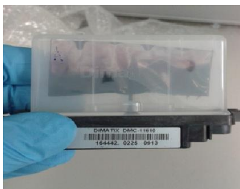
FIGURA 70 – CARTUCHO PREENCHIDO COM A TINTA DE NANOPARTICULAS DE OURO PRODUZIDAS PELO MÉTODO BIFÁSICO
