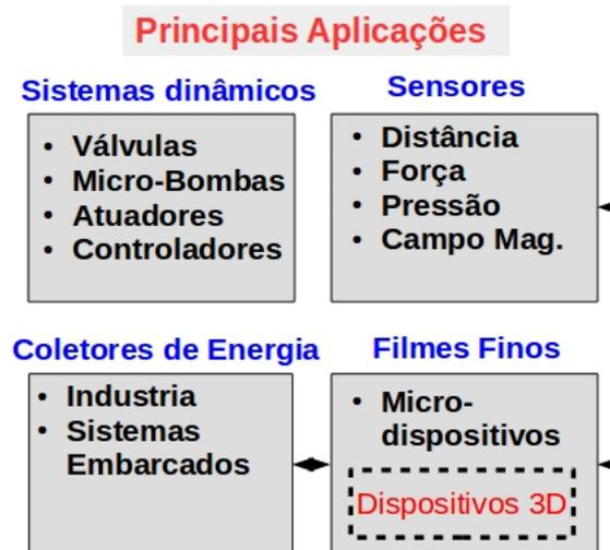
Figura 1.1: Principais áreas e dispositivos que operam com base em ligas de Ni-Mn-Ga com memória de forma. Os dispositivos funcionam à temperatura ambiente.
