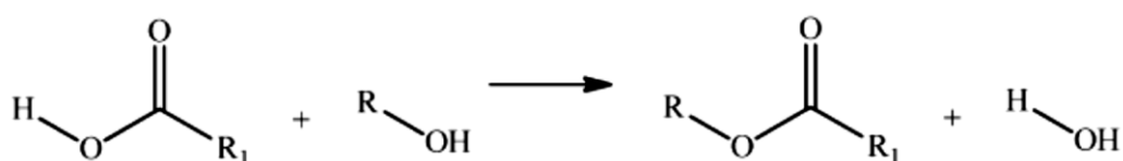
FIGURA 5 - REAÇÃO DE ESTERIFICAÇÃO.
