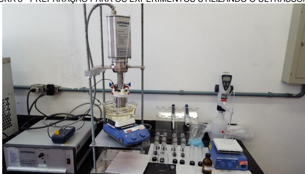
FIGURA 8 - PREPARAÇÃO PARA OS EXPERIMENTOS UTILIZANDO O ULTRASSOM.
