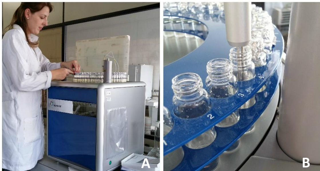
Figura 2. Colocação dos extratos irradiados e não irradiados para determinação do CBM e N_{mic} (A) e equipamento em funcionamento (B).
