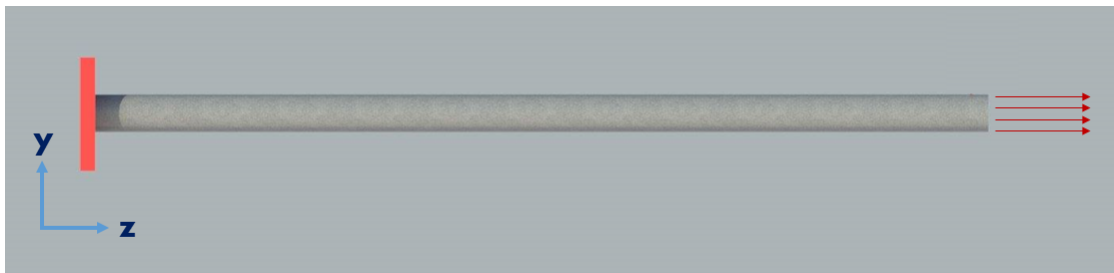
FIGURA 12 – CILINDRO DE AÇO MACIÇO TRACIONADO.
