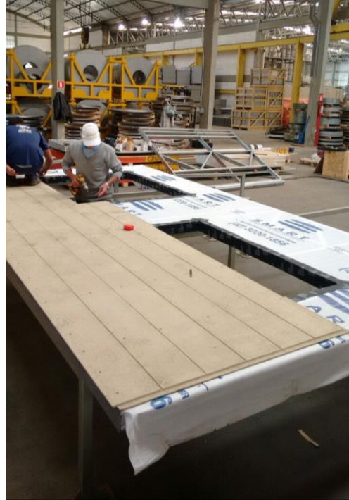
Figuras 23 e 24 – Instalação do isolamento em lã de vidro
