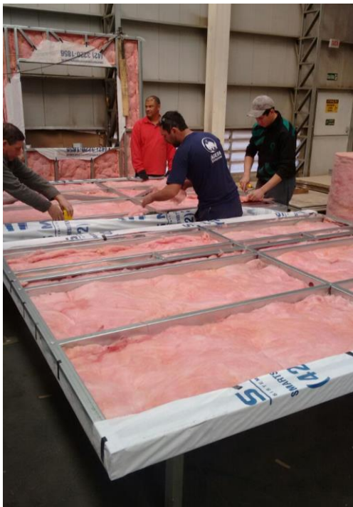
Figuras 23 e 24 – Instalação do isolamento em lã de vidro
