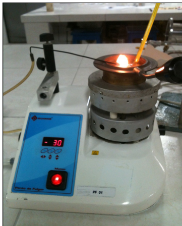
FIGURA 10 - FOTO DO EQUIPAMENTO PARA DETERMINAR O PONTO DE FULGOR EM VASO ABERTO.
