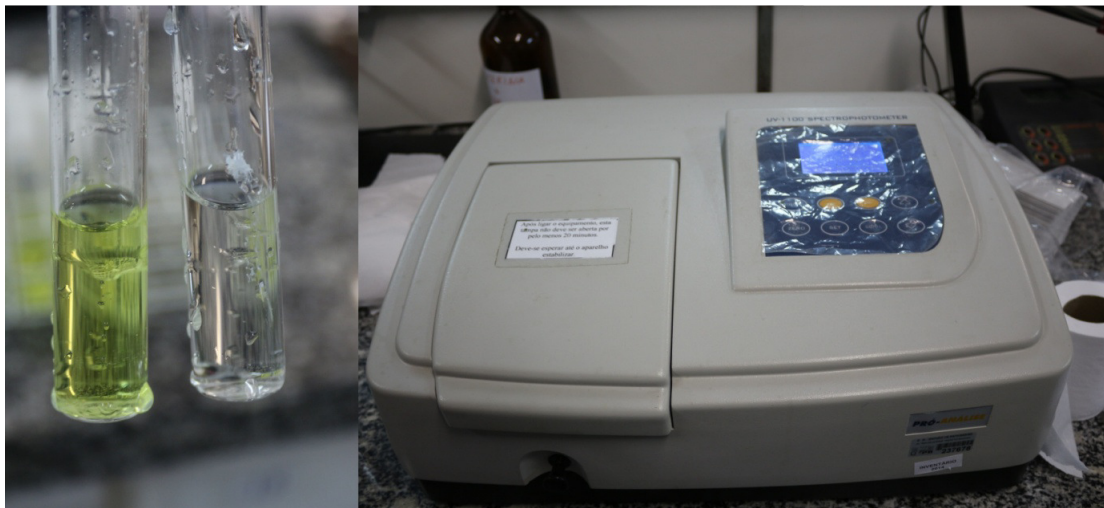
FIGURA 14 - FOTO DA SOLUÇÃO CONTENDO O CROMÓFORO 3,5 DIACETIL-1,4DIHIDROLUDINA A ESQUERDA COMPARADA COM A SOLUÇÃO ISENTA DESTE COMPOSTO. EQUIPAMENTO DE UV/VIS UTILIZADO PARA A REALIZAÇÃO DAS LEITURAS DE ESPECTROMETRIA.
