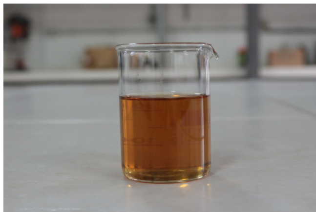
FIGURA 19 - FOTO DA GLICERINA LOIRA ANTES DA PURIFICAÇÃO COM ADSORVENTES.
