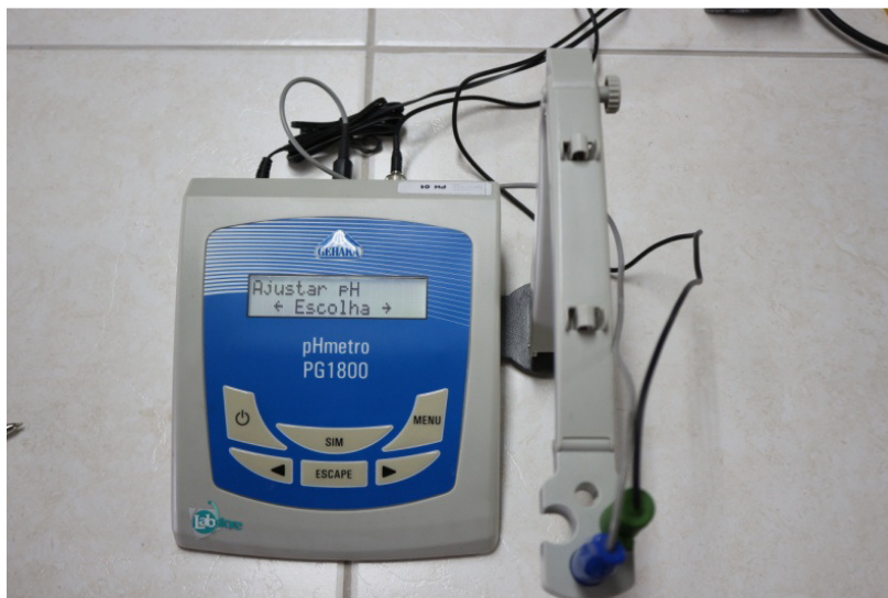
FIGURA 16 - FOTO DO PHMETRO GEHAKA PG 1800 UTILIZADO PARA AS LEITURAS DO POTENCIAL HIDROGENIÔNICO DAS ARGILAS.
