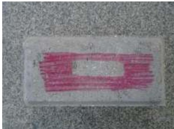
(b) Paver após o ensaio de abrasão
