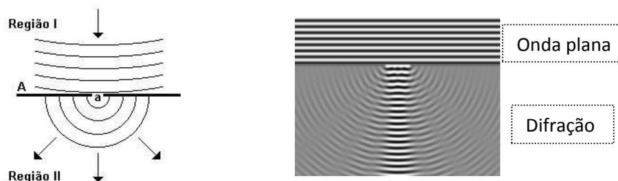
Figura 4.1 Imagem de uma onda plana espalhada por um obstáculo ou um orifício com dimensões comparáveis ao comprimento de onda[27].
