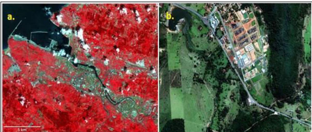
FIGURA 6 – COMPARAÇÃO DAS DIFERENTES REFLECTÂNCIAS DA VEGETAÇÃO: (A) IMAGEM INFRAVERMELHA OBTIDA PELO SENSOR ASTER, SATÉLITE DA NASA NA ÓRBITA DA TERRA. AS ÁREAS EM VERMELHO SÃO DE VEGETAÇÃO. (B.) IMAGEM OBTIDA PELO SATÉLITE WORDVIEW-2, AS ÁREAS EM VERDE SÃO DE VEGETAÇÃO.
