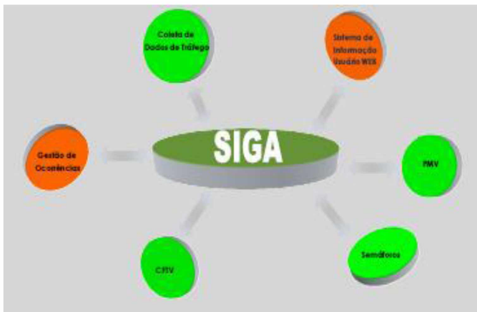
Figura 22 - Estrutura do SIGA – Sistema integrado de apoio e gestão ao tráfego Fonte: SIM (2011)
