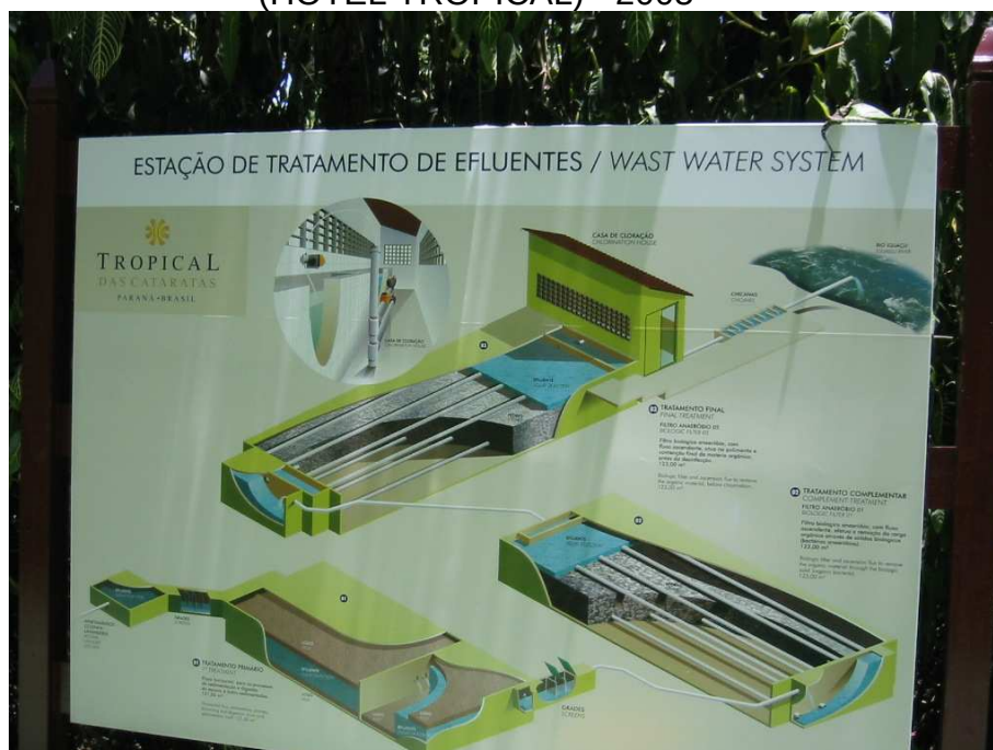
FIGURA 24 – PAINEL DEMONSTRANDO O MECANISMO DE AÇÃO DA ETE (HOTEL TROPICAL) - 2005
