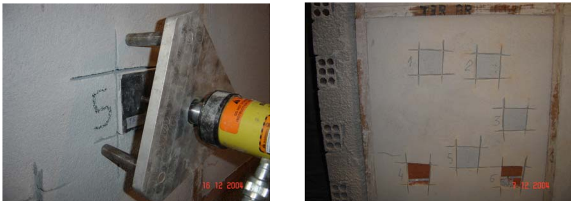
Figura 19 – Ensaio de resistência de aderência à tração
