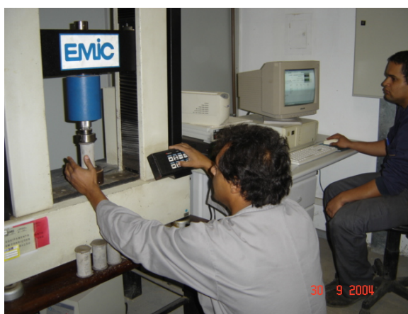
Figura 15 – Ensaio de resistência à compressão
