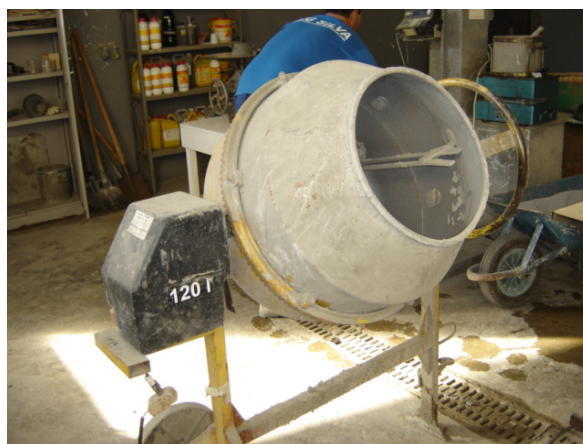
Figura 12 – Betoneira de eixo inclinado com capacidade de 120 litros
