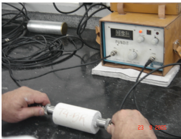
Figura 18 – Determinação do tempo em que a onda ultra-sônica percorre o corpo de prova 50 mm x 100 mm utilizando o PUNDIT
