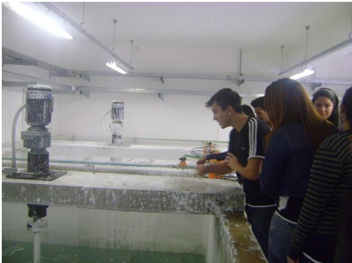
Figura 5 - Tanque de reagentes- Hidróxido de cálcio, usado na correção do pH.
