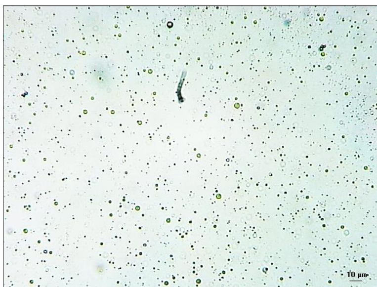
Figura 27 - Fotomicrografia das microcápsulas de PUF com óleo de linhaça encapsulado, aumento de 100 x.
