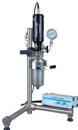
FIGURA 18. Reator utilizado nos experimentos de desidratação
