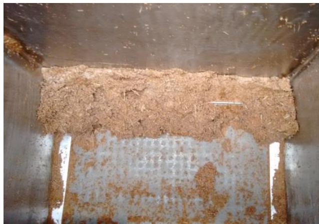
FIGURA 16 – IMAGEM DO LEITO AGLOMERADO NO TERMOPAR NA ALTURA DE 5 CM DE LEITO NO FINAL DO CULTIVO MIX-5 26 FONTE: A AUTORA (2016)
