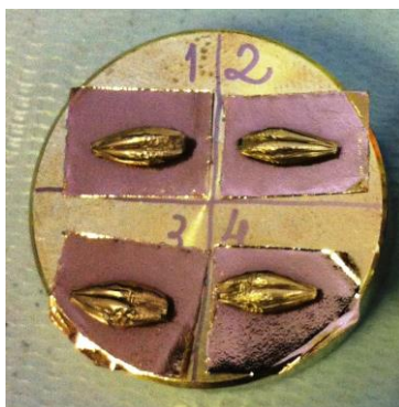
Figura 3.2 Amostras Recobertas por uma Camada de Ouro.
