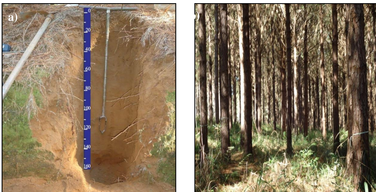
FIGURA 1: (a) Perfil de Latossolo Vermelho Amarelo Distrófico típico localizado no barranco em área com Pinus taeda L, município de Jaguariaíva (PR), setor SB e (b) paisagem de ocorrência.
