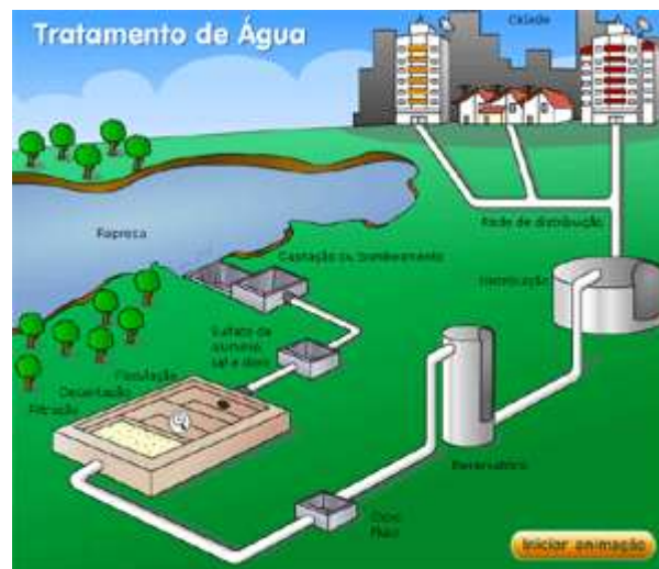
FIGURA 1 – CROQUIS ESQUEMÁTICO DE UMA ETA
