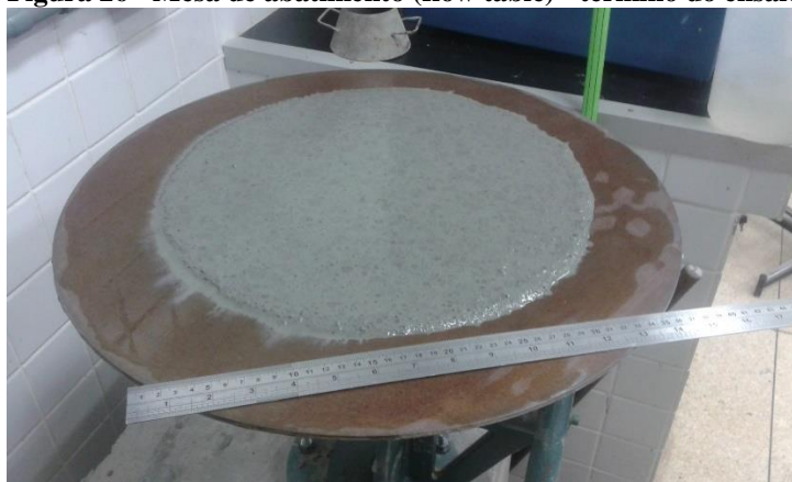
Figura 26 - Mesa de abatimento (flow table) - término do ensaio
