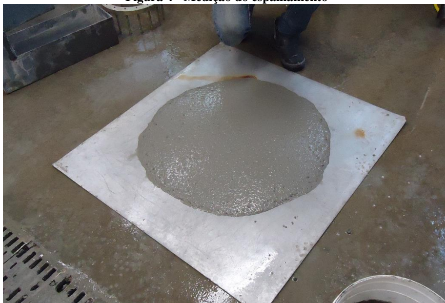
Figura 4 - Medição do espalhamento
