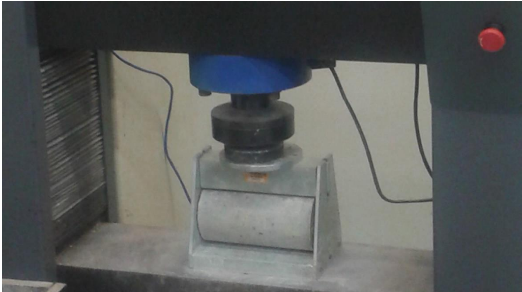
Figura 38 - Adaptador para ensaio de resistência à tração por compressão diametral
