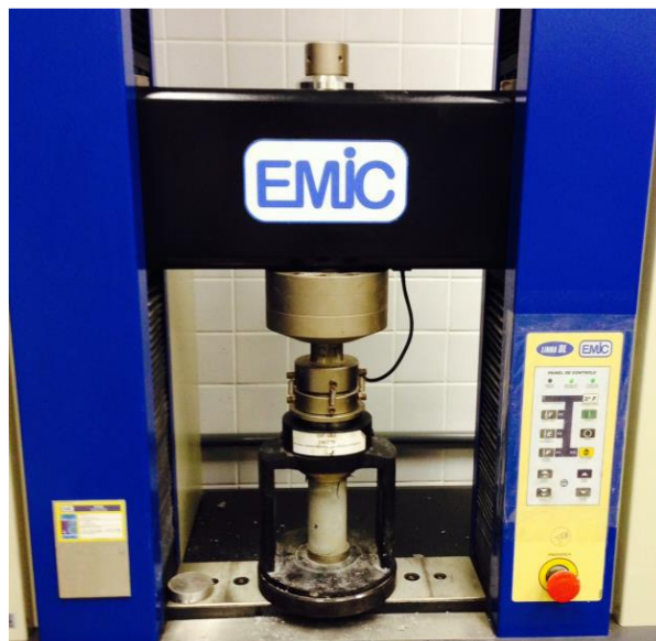
Figura 29 - Rompimento corpo de prova - Argamassa
