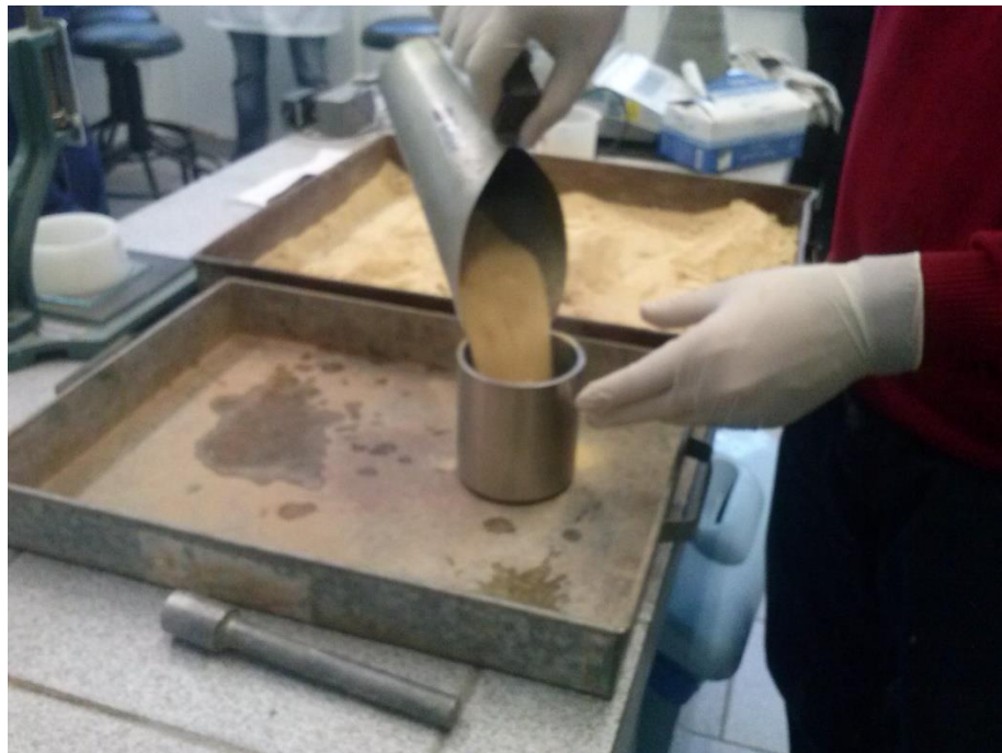
Figura 30 – Determinação esqueleto granula - Medição do empacotamento
