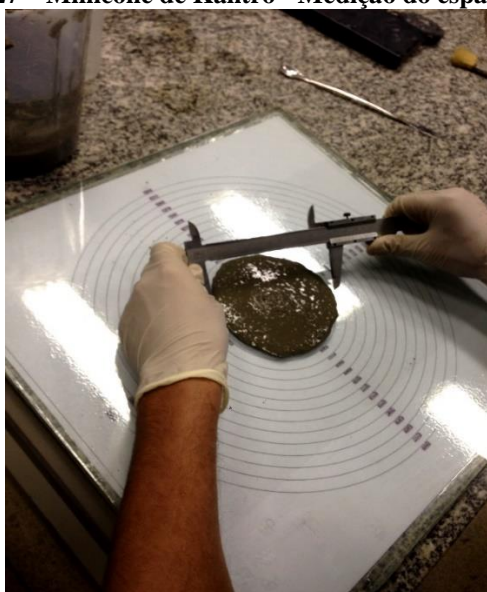
Figura 27 – Minicone de Kantro - Medição do espalhamento
