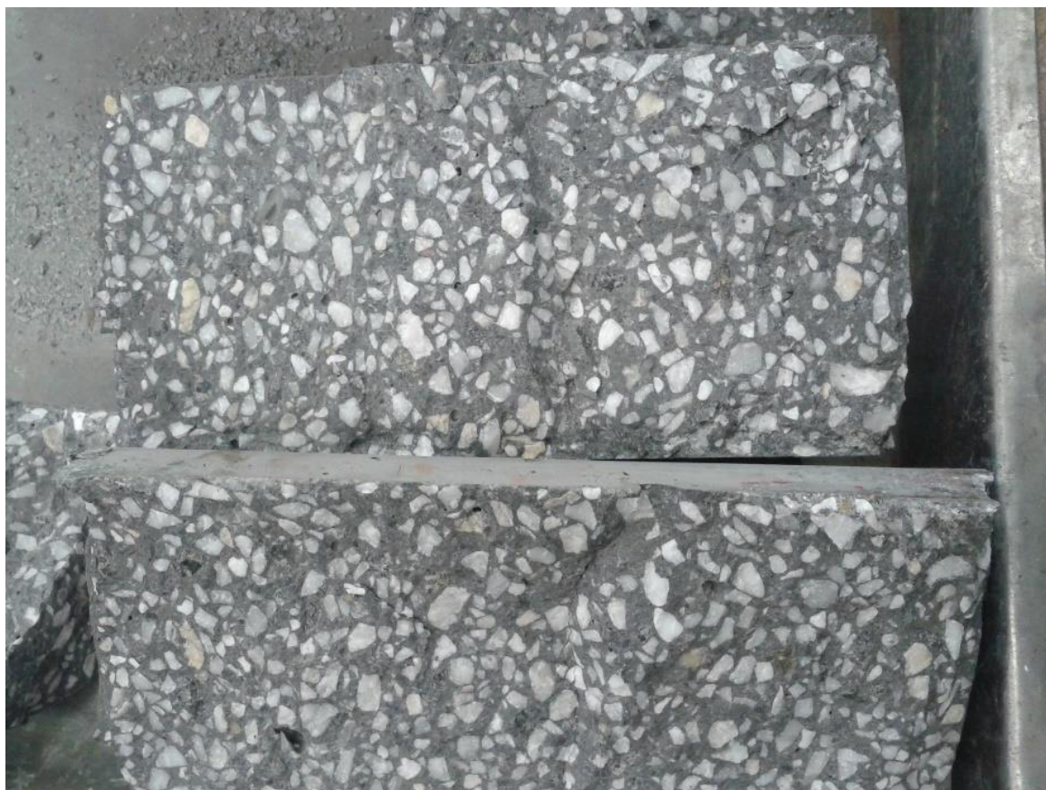
Figura 46 - Corpo de prova - Rompimento nos agregados graúdos
