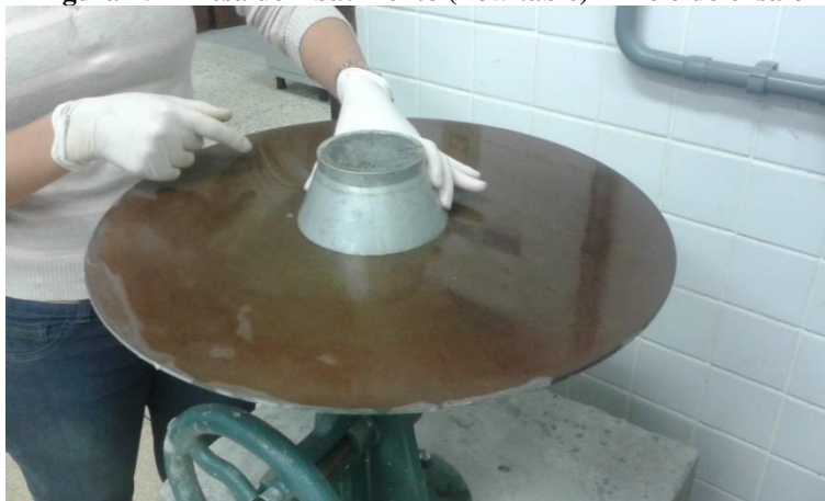
Figura 25 - Mesa de Abatimento (flow table) - início do ensaio
