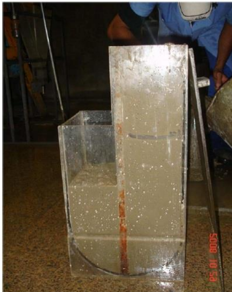
Figura 11 – Ensaio da caixa U ( U-box test )
