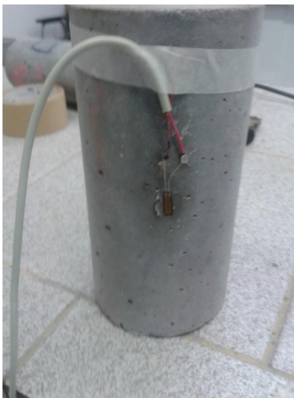
Figura 35 - Corpo de prova com strain gage instalado
