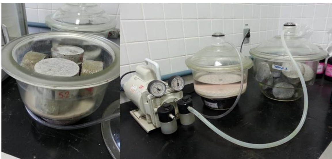
Figura 35 – Processo de saturação das fatias de concreto para o ensaio de migração
