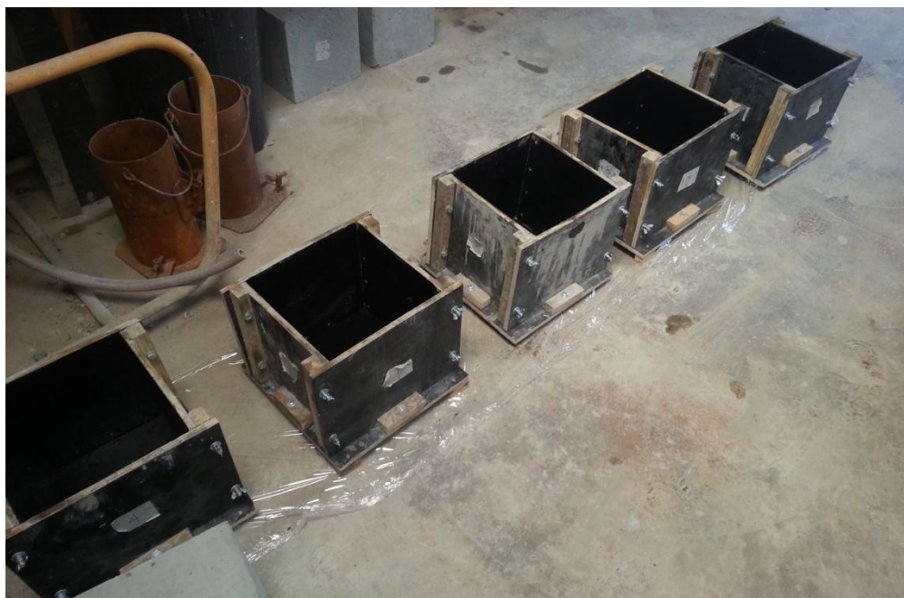
Figura 31 – Formas para moldagem dos corpos de prova para avaliação da resistividade elétrica
