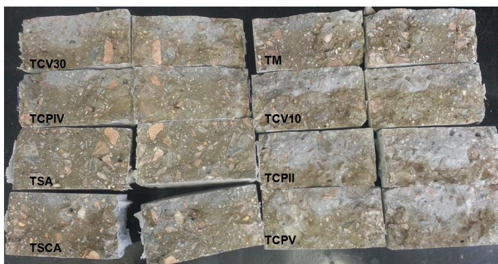
Figura 40 – Indicação da região com cloretos livres para os traços ensaiados
