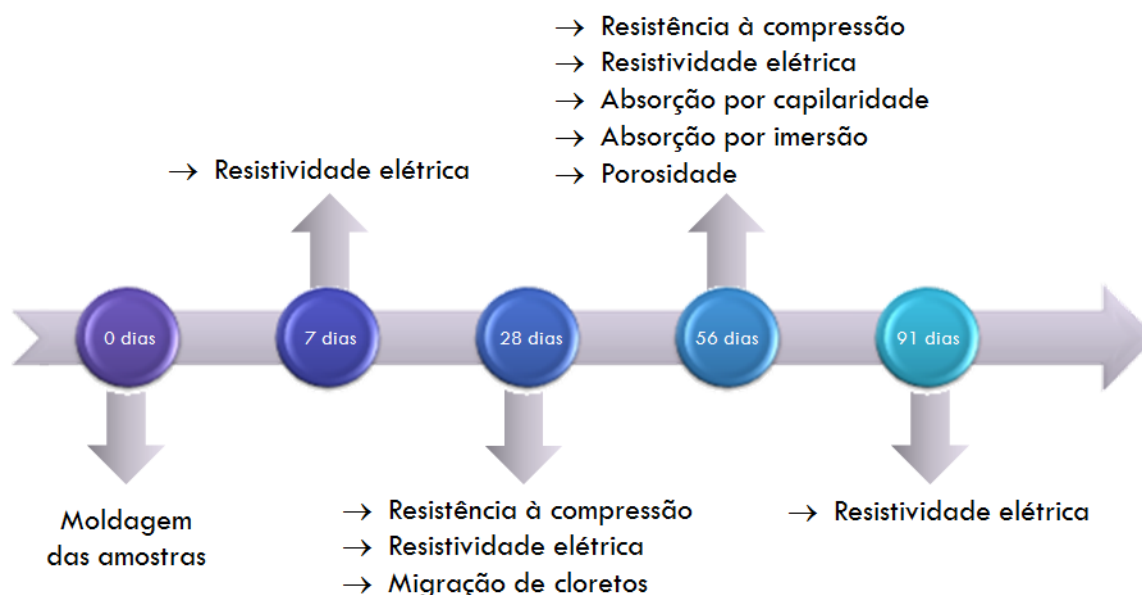
Figura 26 – Esquema temporal dos ensaios realizados
