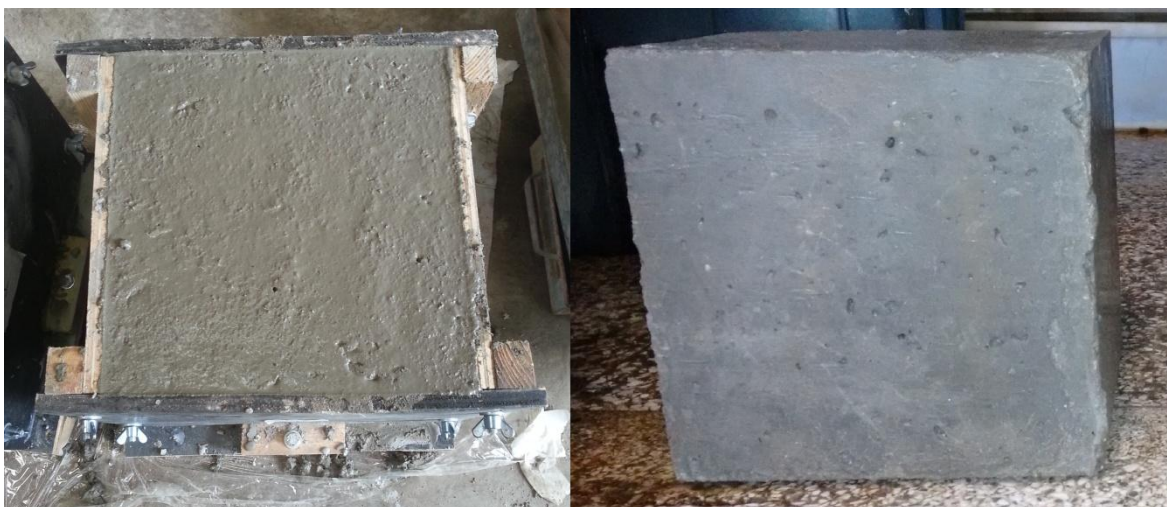
Figura 32 – Corpos de prova cúbicos para avaliar a resistividade elétrica
