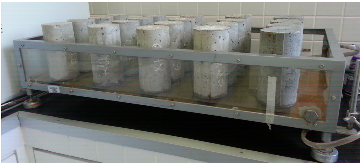
Figura 30 – Ensaio de absorção por capilaridade
