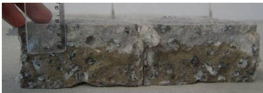
Figura 39 - Precipitação branca de cloretos livres e região livre de cloretos em marrom Fonte: Medeiros et al. (2009)
