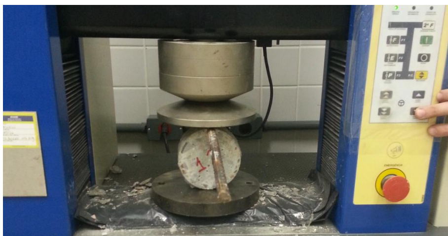
Figura 38 – Ruptura ao meio das fatias do ensaio de migração
