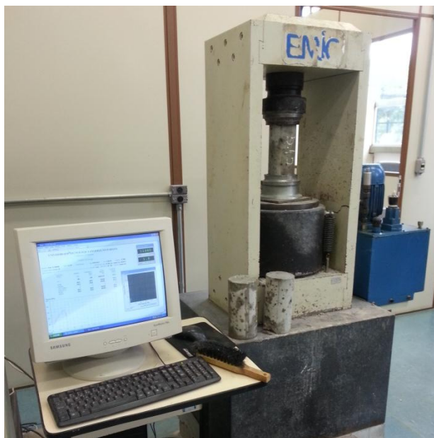
Figura 28 – Ruptura dos corpos de prova
