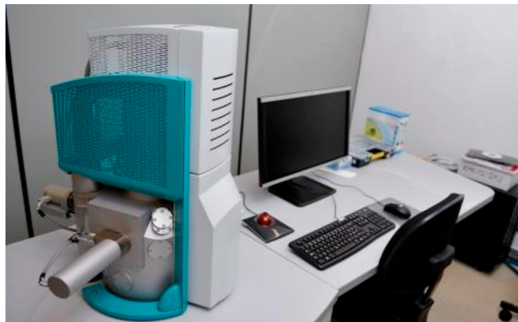
FIGURA 24 - EQUIPAMENTO DE MEV
