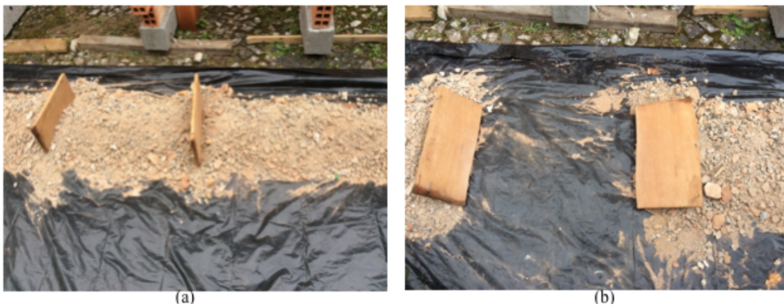
FIGURA 14 - RETIRADA DA AMOSTRA: (A) DELIMITAÇÃO DO TAMANHO DA AMOSTRA. (B) AMOSTRA COLETADA
