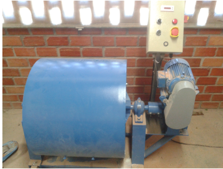
FIGURA 25 - EQUIPAMENTO DE ABRASÃO LOS ANGELES
