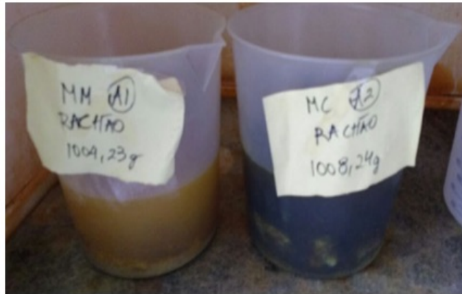
FIGURA 22 - SEGUNDA ETAPA DO ENSAIO DE TEOR DE ARGAMASSA ADERIDA: IMERSÃO DO AGREGADO EM ÁCIDO
