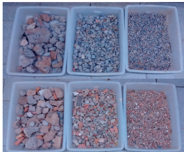
FIGURA 16 - RACHÃO, BRITA E PEDRISCO DE MATERIAL CONCRETO E MISTO DO BRITADOR DE IMPACTO
