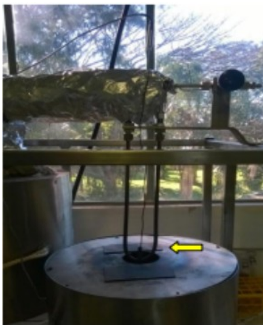
FIGURA 13 - FOTO DO REATOR ACOPLADO AO REFORMADOR
