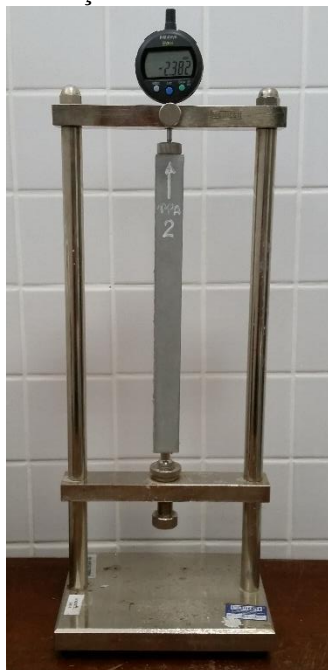
Figura 3.15 – Ensaio de variação dimensional – leitura do corpo de prova.
