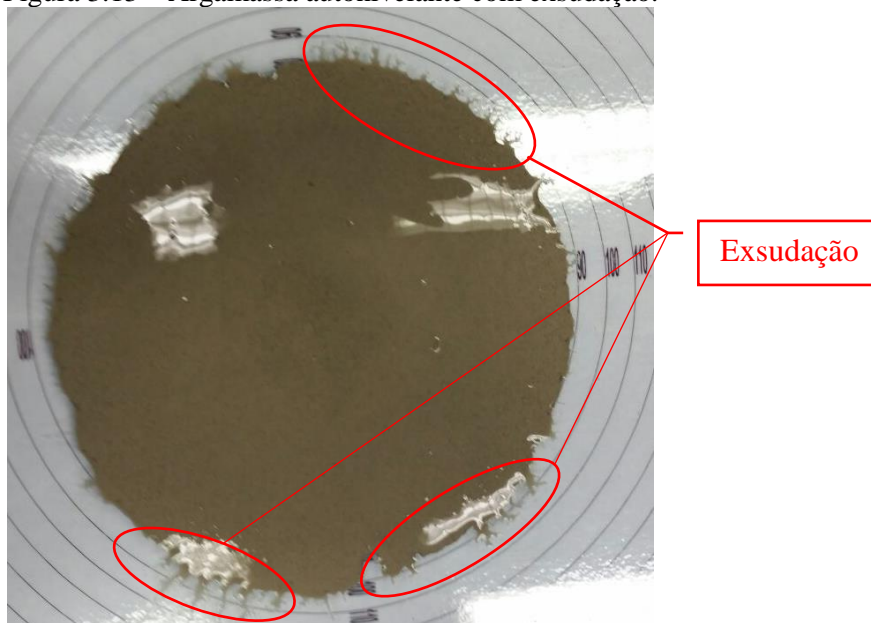
Figura 3.13 – Argamassa autonivelante com exsudação.
