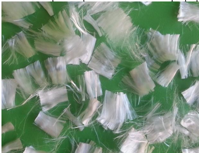
Figura 2.10 – Exemplo do aspecto visual das fibras de polipropileno.
