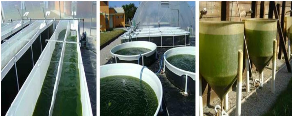
FIGURA 5 - ESTRUTURA DOS TANQUES UTILIZADOS NO CULTIVO DA MICROALGA N. oculata . DA ESQUERDA PARA A DIREITA, TANQUES DO TIPO “RACEWAYS”, TANQUES CIRCULARES E TANQUES DE FLOCULAÇÃO.
