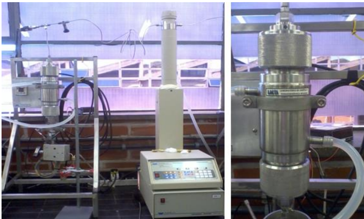
FIGURA 7 - IMAGEM DO VASO DE PRESSÃO, CONTROLADOR E BOMBA SERINGA UTILIZADOS PARA AS EXTRAÇÕES COM FLUIDO PRESSURIZADO E, À DIREITA, UMA AMPLIAÇÃO DO VASO EXTRATOR.
