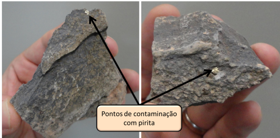
Figura 18. Exemplo de aleatoriedade da pirita na rocha base para o agregado miúdo ensaiado.
