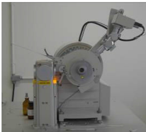
Figura 27. Equipamento para realização do ensaio de DRX.
