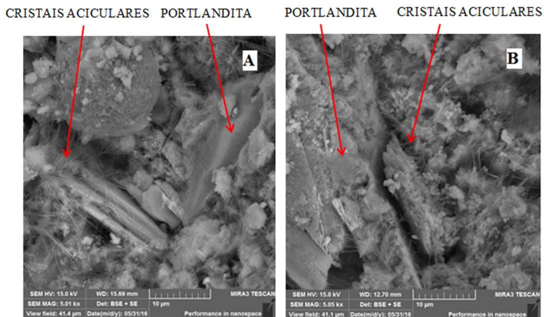
Figura 105. Presença de etringita nas pastas Ref. (0,0%) aos 168 dias (A- ciclo de molhagem e secagem e B – tanque aerado).
