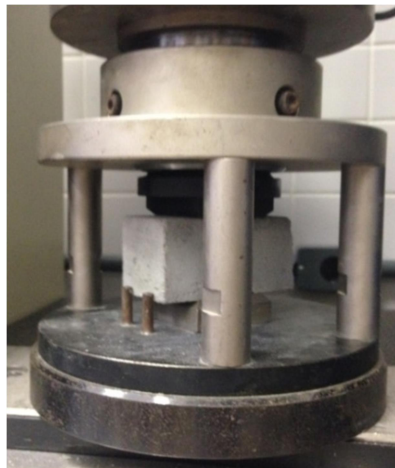
Figura 23. Aplicação de carga no ensaio de compressão nos corpos de prova prismáticos.
