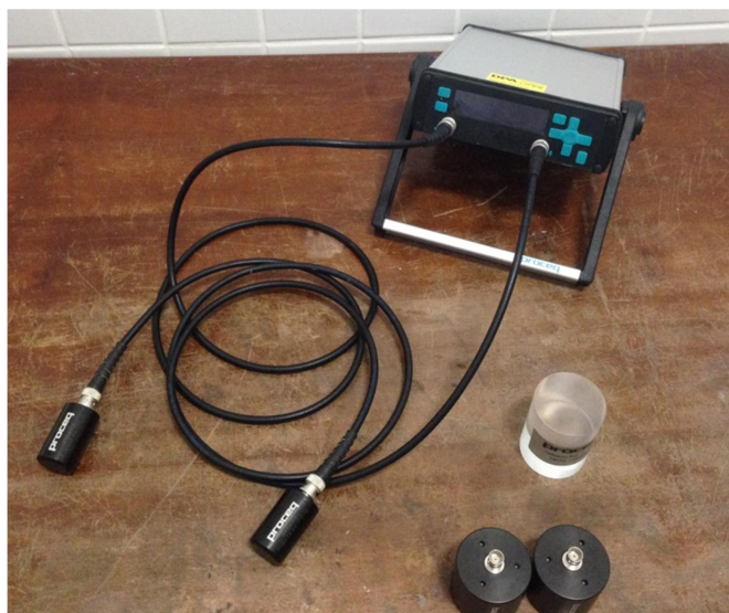
Figura 24. Equipamento Ultrasonic Pulse Velocity – Pundit Lab.
