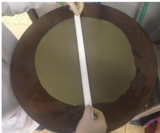
Figura 21. Ensaio de consistência de argamassas.
