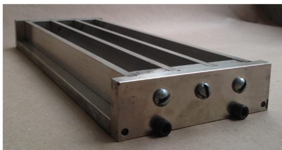
Figura 25. Chapas das extremidades dos moldes para fixação dos pinos.
