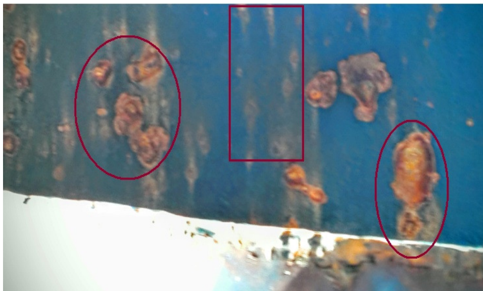
Figura 20 - Corrosão causada pela ação da cavitação em carcaça de bomba centrífuga de ferro fundido Fonte: Autor (2014).
