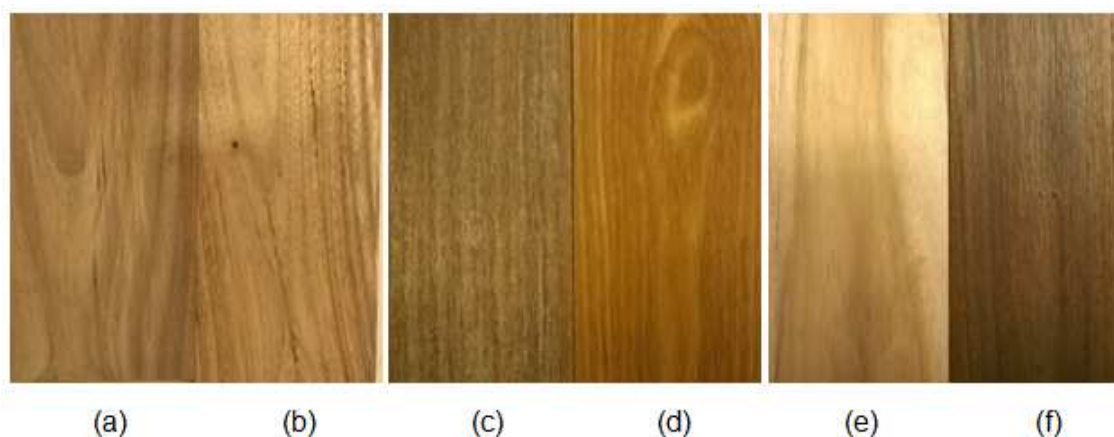
FIGURA 12 – VARIAÇÃO DE COR DA MADEIRA DEVIDO À APLICAÇÃO DO ACABAMENTO. (a) BRACATINGA SEM VERNIZ; (b) BRACATINGA COM VERNIZ; (c) CUMARU SEM VERNIZ; (d) CUMARU COM VERNIZ; (e) TECA IN NATURA; (f) TECA TINGIDA. FONTE: A AUTORA, 2014.
