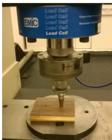
FIGURA 8 – EQUIPAMENTO EMIC MODELO DL 30000, CAPACIDADE MÁXIMA DE 30 TONELADAS, PARA ENSAIO DE DUREZA.
