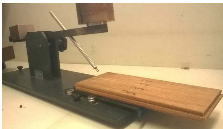
FIGURA 6 – EQUIPAMENTO UTILIZADO PARA OS TESTES DE RISCO FEITOS COM UMA PONTEIRA ARREDONDADA E PESOS DE 4 KG E 5 KG.
