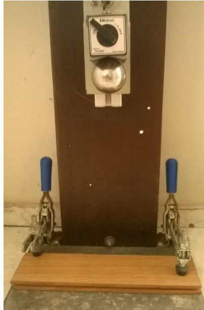
FIGURA 7 – IMPACTÔMETRO PARA ANALISAR A RESISTÊNCIA DA MADEIRA AO IMPACTO. FONTE: A AUTORA, 2014.
