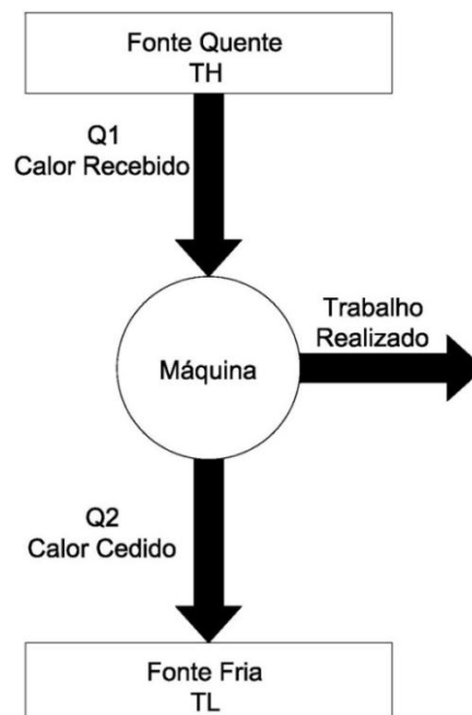
Figura 01 – Fluxograma da máquina térmica.
