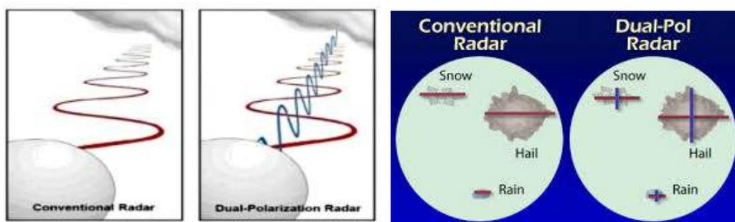
FIGURA 7: DIFERENÇA NA EMISSÃO E DETECÇÃO DE PARTÍCULAS ENTRE UM RADAR DE POLARIZAÇÃO SIMPLES E UM RADAR DE POLARIZAÇÃO DUPLA.
