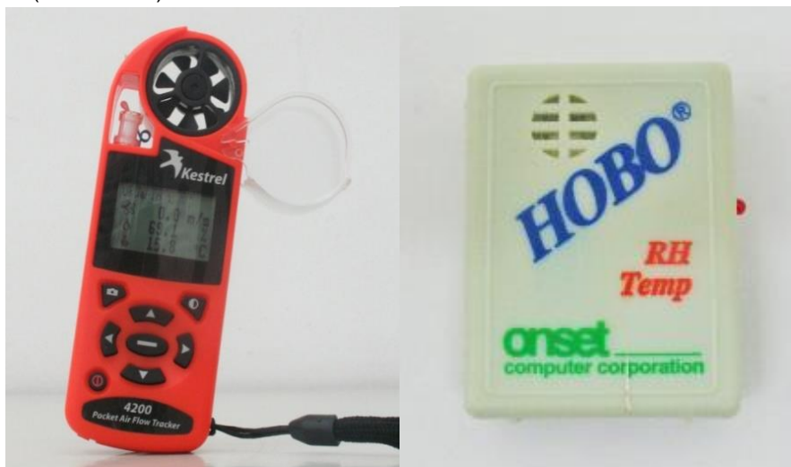
FIGURA 5 - EQUIPAMENTOS UTILIZADOS: MINIESTAÇÃO KESTREL® 4200 POCKET (À ESQUERDA) E REGISTRADORES MODELO HOBO® DATA LOGGER RH & TEMP (À DIREITA)
