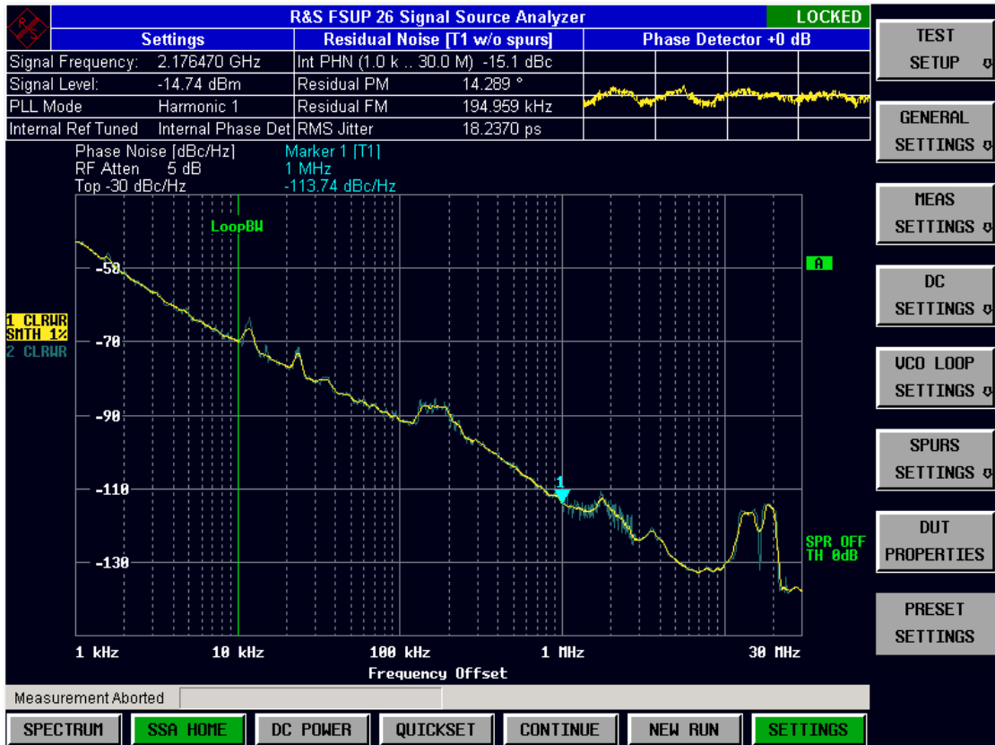
Figura 62 – Resultado do ruído de fase medido para o circuito 3 com if = 320 .
