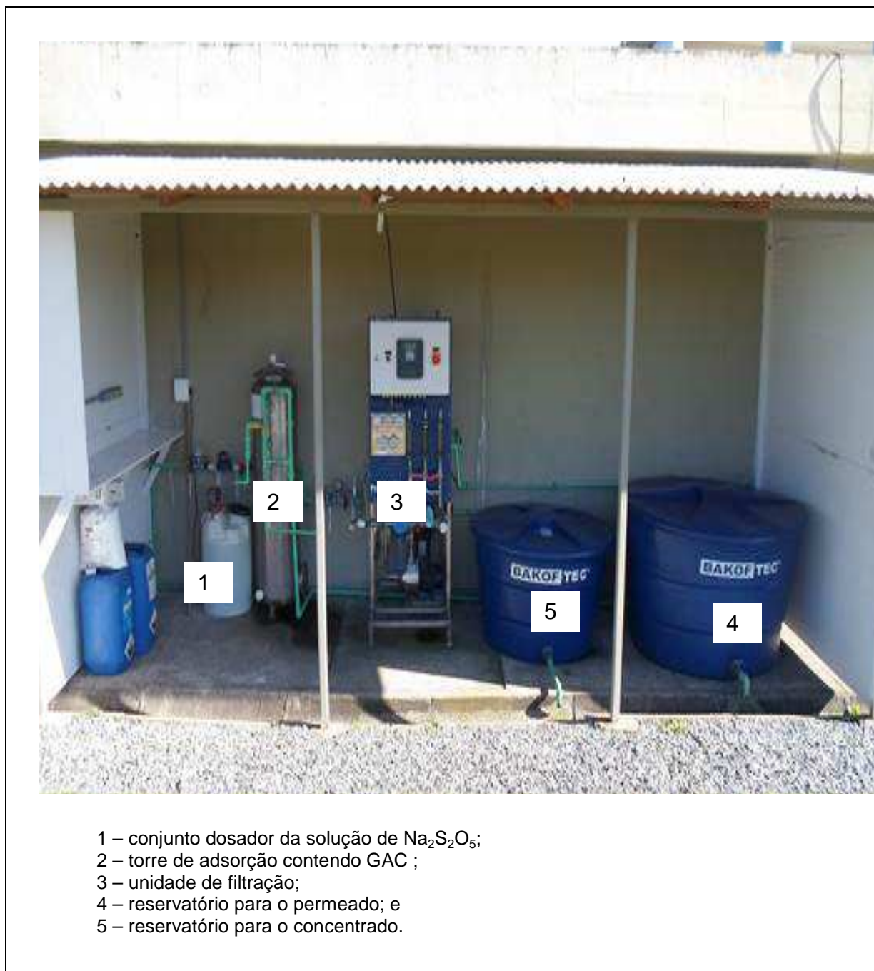
FIGURA 3.5 – UNIDADE PILOTO DE OSMOSE REVERSA
