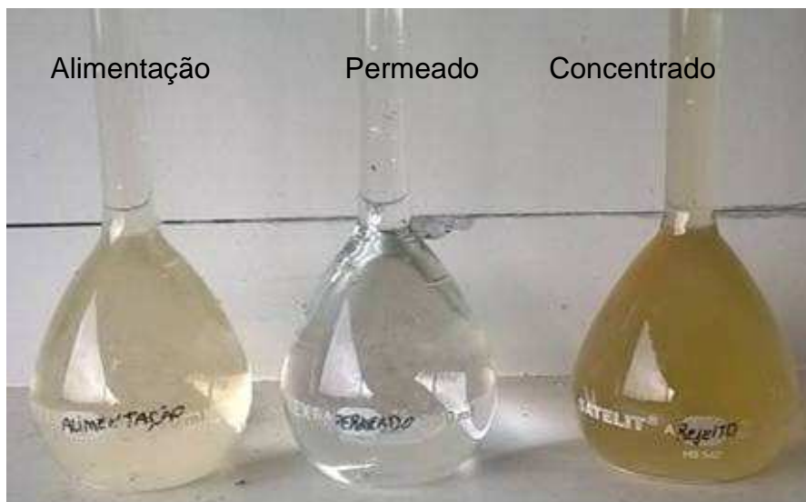
FIGURA 4.1 – AMOSTRA DE ÁGUA DE ALIMENTAÇÃO (A), PERMEADO (P) E CONCENTRADO (C) EM ÉPOCA DE BAIXA PLUVIOSIDADE E DOSAGEM DE DIÓXIDO DE CLORO INSUFICIENTE
