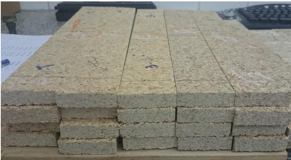
**FIGURA 8 - CORPOS DE PROVA PARA TESTES DE FLEXÃO ESTÁTICA**
