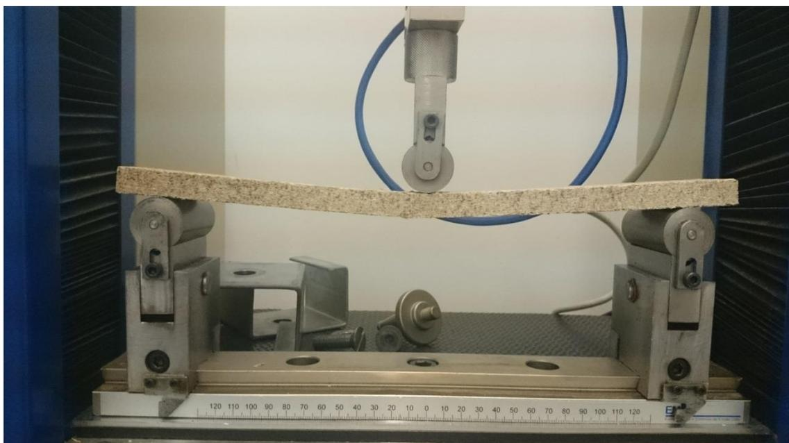
**FIGURA 11 – TESTE DE FLEXÃO ESTÁTICA**
