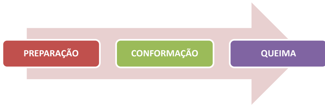
Figura 1 - Etapas básicas nos processos de produção de tijolos, telhas cerâmicas
