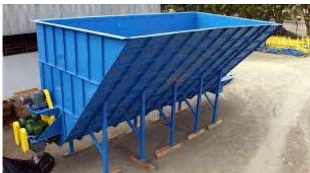
Figura 4 - Alimentador automático de cavaco utilizados nas indústrias Candido de Abreu e S. Mazzuco, localizadas em Cândido de Abreu – Paraná – abril de 2015
