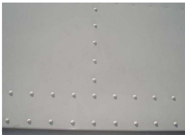
FIGURA 3 – União de chapas rebitadas na fuselagem de aeronave
