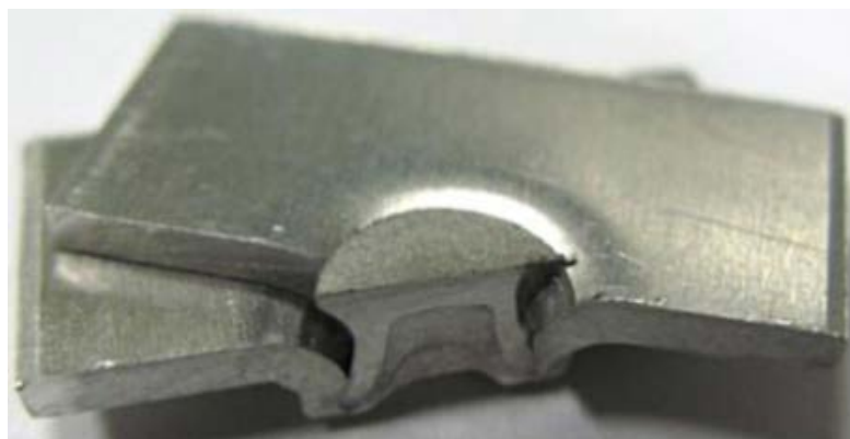
FIGURA 5 – Corpo de prova de rebiteagem auto perfurável
