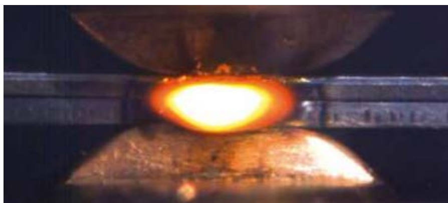
FIGURA 2 – Formação do ponto de solda
